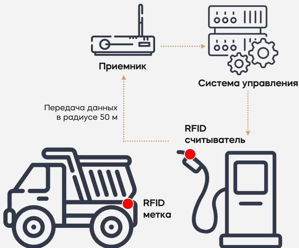
Беспроводной считыватель меток устанавливается на топливораздаточный пистолет и служит для считывания кода RFID-метки во время инициализации заправки.
